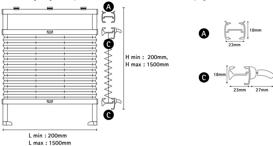
EDF30, boîtier fixe, guidage acier, profil de jonction et bas coulissants, manœuvre 2 poignées, 2 toiles
